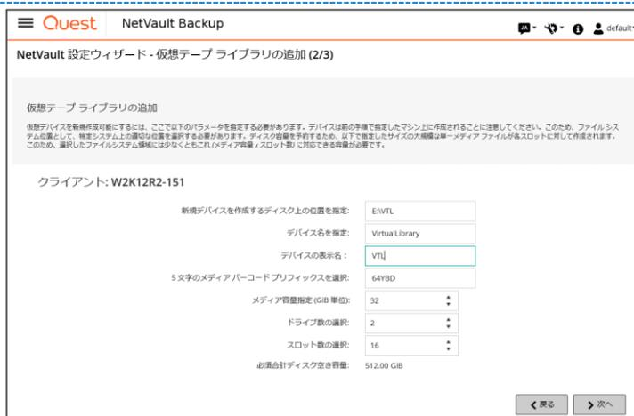
仮想テープライブラリの作成の為に、最終的に使用されるディスク容量は Web GUI 下部にある、「必須合計ディスク空き容量」に表示されますので、作成先ディスクの空き容量の範囲内に収まるようご注意ください。計算方法は、メディア容量 x スロット数 となります。
