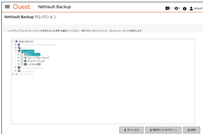
4 バックアップに使用するプラグインをダブルクリックすると、バックアップ対象として選択されるデータが表示されます。
