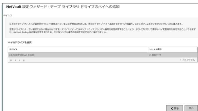
(3) この画面では追加対象ドライブが複数のクライアントに共有接続されて、共有ドライブとしたい場合、リストされたクライアントを選択し、[次へ] をクリックしてください。
